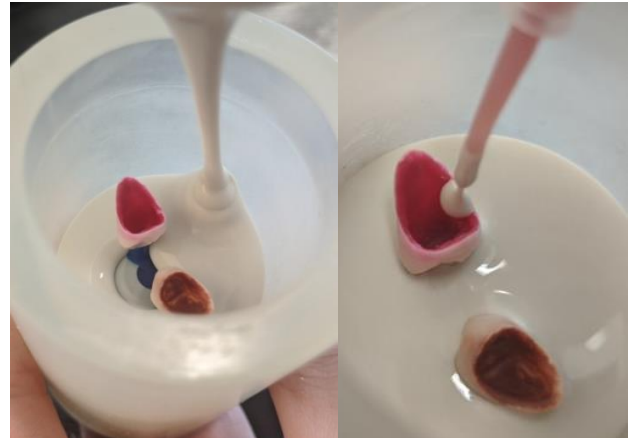
Abb.12 Einbetten der Wachsobjekte
