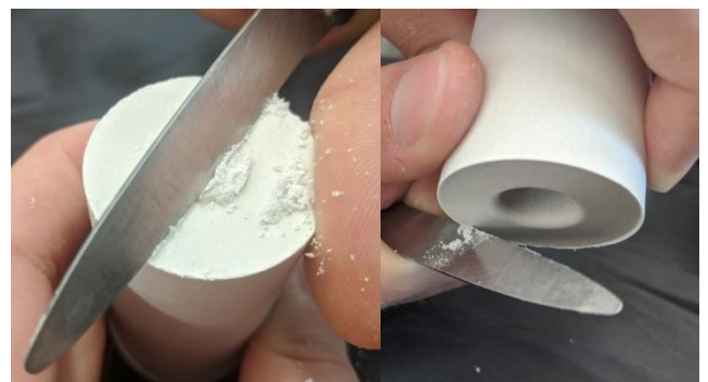
Abb.14 Kanten brechen und begradigen
