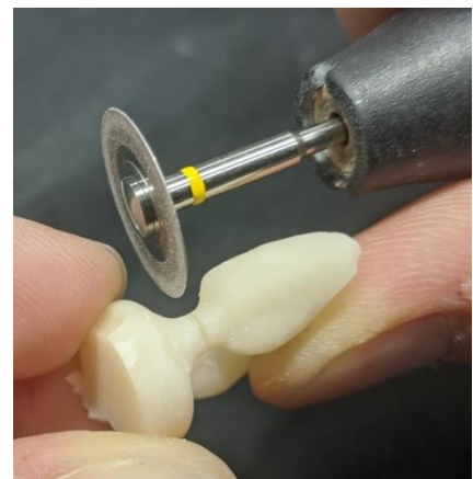
Abb.20 Abtrennen der Pressobjekten
